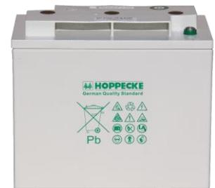
Die von Power-Blox eingesetzten Batterien haben Zyklusfestigkeiten von 2'500 – 3'500 Zyklen bei 50% Entladetiefe. Diese Entladetiefe wird jedoch bei den von uns empfohlenen Konfigurationen in der Praxis nur selten erreicht. In den meisten Fällen wird die Batterie nur um 20% - 30% entladen, was die Zyklusfestigkeit auf 4'000 – 5'500 Zyklen ansteigen lässt. Dies entspricht einer zu erwartenden Lebensdauer von 10 bis 15 Jahren.
